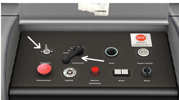
Halten Sie dann die Straßenbahn an, bewegen Sie den Griff in die neutrale Position (siehe Bild), klicken Sie erneut auf die Taste, um die Hecksteuerung auszuschalten, und klicken Sie auf die Abdeckung, um sie zu schließen.
